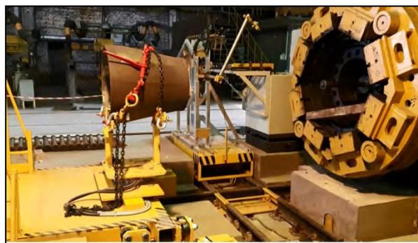
**2.3.3. Роботизированный станок-автомат для индукционной термообработки деталей с блоком лазерной маркировки и автоматического определения твердости обработанных деталей.**
