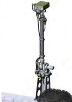
Развертываемая мачта с приводами наклона и вращения телекамер
