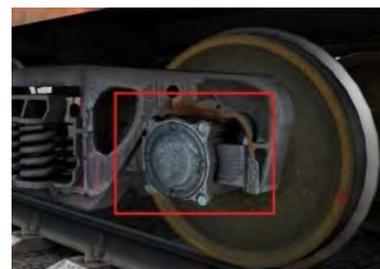
Беспроводные модули по радиоканалу передают данные в головной модуль, например, сообщения о превышении предупредительного или аварийного порога температуры, вибрации и уровня акустических шумов.
