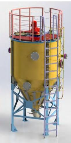
Предназначены для очистки загрязненной воды или моющих растворов от крупных механических примесей, песка, тяжелых шламов и от всплывающих примесей (масел, нефти и легких нефтепродуктов).
