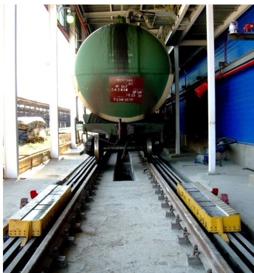
Положение толкателей тележки тяговой во время рабочего хода
