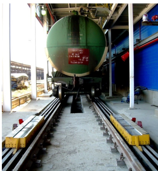
Положение толкателей тележки тяговой во время рабочего хода
