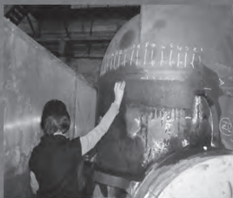
Контроль крестовины задвижки DN1000 ультразвуковым методом и комплексом «ПСКлм»
