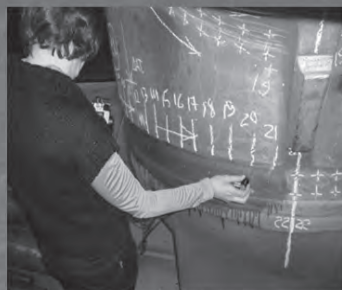
Контроль крестовины задвижки DN1200 ультразвуковым методом и комплексом «ПСКлм»
