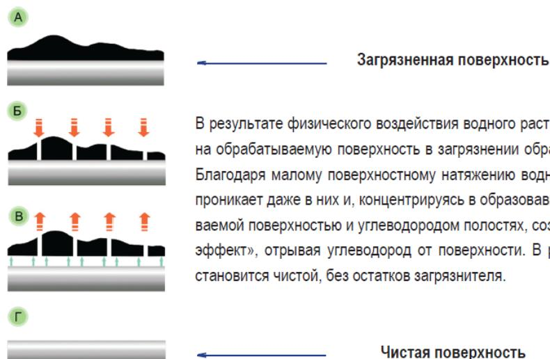
Деэмульгирующая способность является основой водных растворов серии «**О-БИС**» для ведения отмывки в замкнутом, бессточном режиме, так как загрязненный водный моющий раствор разделяется после отмычки на твердые взвешенные частицы, отмытый углеводород и водный моющий раствор, который, в свою очередь, может быть использован многократно.
