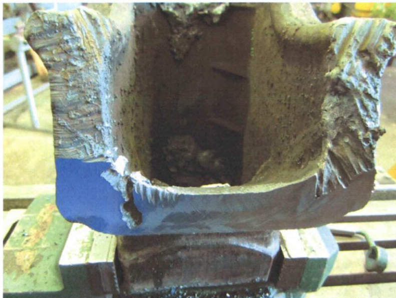
Фото 2. Газовая раковина в полости металла размером 10х20 мм в боковой раме № 00055
