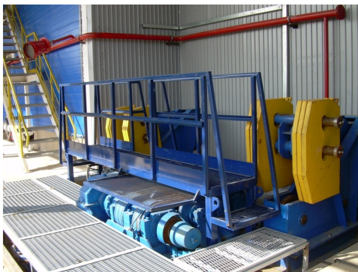
Положение толкателей тележки тяговой во время холостого хода
